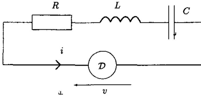
On appelle  $D_1$ ,  $D_2$  et  $D_3$  respectivement les domaines  $i < -i_0$ ,  $-i_0 \leq i \leq i_0$  et  $i > i_0$ . La pente positive des domaines  $D_1$  et  $D_3$  est notée  $R_p$ . La pente du domaine  $D_2$  est notée  $-R_n$ . La caractéristique admet pour centre de symétrie l'origine du repère.
